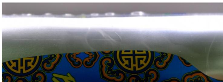
图 13 加热不均匀导致油墨出现雾状, ECKART®
