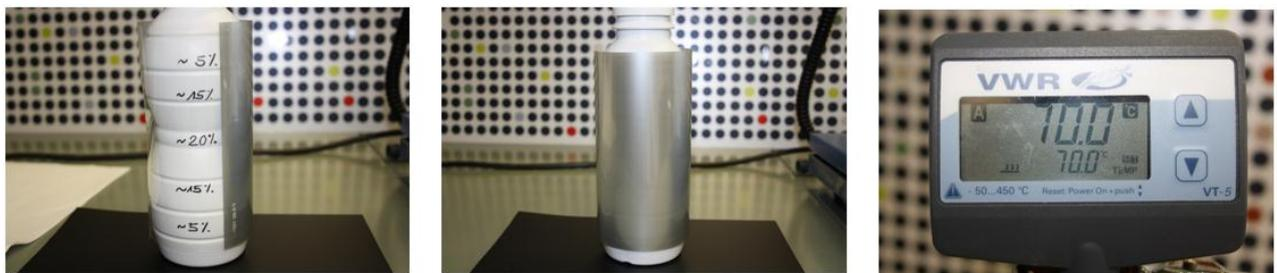
图 10 实验室模拟收缩过程: 印样包裹瓶身, 70°C 水浴, ECKART®
