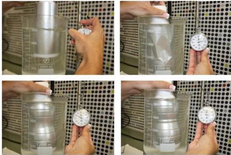
图 11,实验室模拟收缩过程, 水浴 70°C, ECKART®
