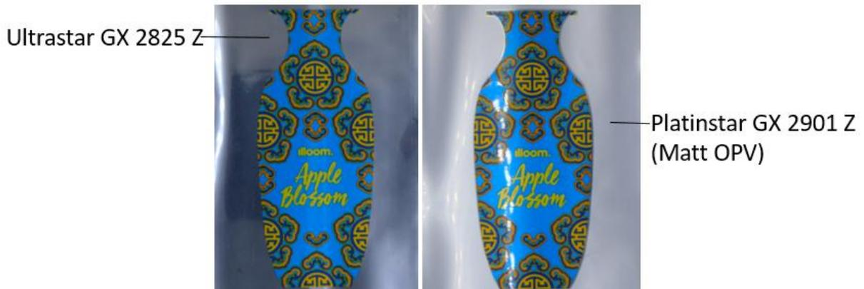
图 16 设计中 镜面与柔光效果对比，左侧镜面，右侧施加哑光油
