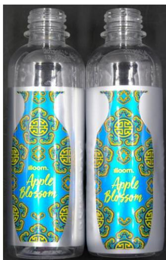
图 17 收缩率较低的设计中收缩后金属光泽的对比，PVD（左），薄元（右侧）
